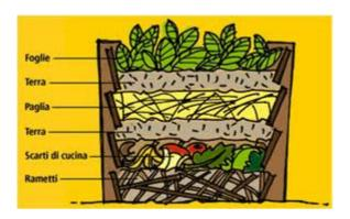
Nel processo di compostaggio la sostanza organica viene aggredita da una miriade di microrganismi viventi che, in varie fasi e in presenza di ossigeno, la decompongono e la mineralizzano, ritrasformandola in vapore acqueo, anidride carbonica e sali minerali che in parte la convertono in eccellente humus. Il processo può essere diviso in 3 fasi principali.
